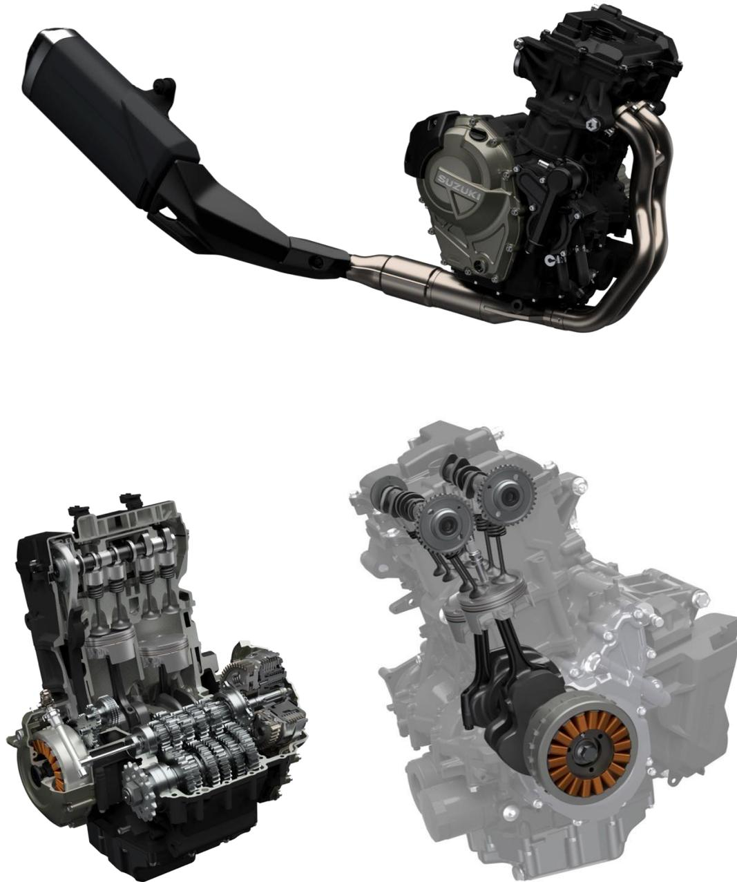
Motor bicilíndrico paralelo de 776 cm<sup>3</sup>, 4 tiempos, 2 cilindros, refrigeración líquida, DOHC
